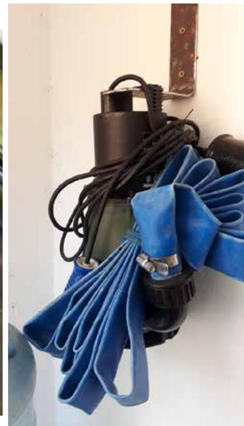
Como elementos de seguridad, hemos incorporado una bomba de achique y otra de incendio para usarlas ante cualquier incidente que surja en las embarcaciones.
